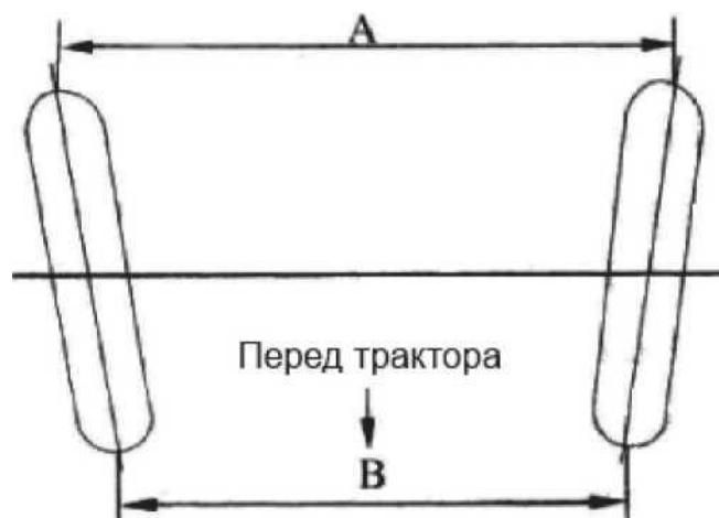
Рис. 3.22. Развал-схождение. Трактор. Вид сверху.
